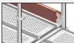
Installazione del fermapiede in legno.
