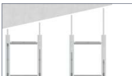
Adattamento alla costruzione La trave intermedia permette, grazie alla lunghezza variabile, di adattare facilmente le sezioni di estremità della struttura alla costruzione
